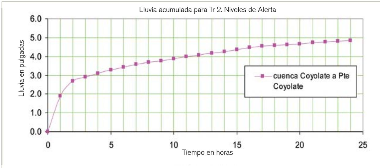
**FIGURA 3-4:** Lluvia acumulada horaria para niveles de alerta; hasta la Estación Puente Coyolate (calculada con datos de lluvia máxima diaria)
