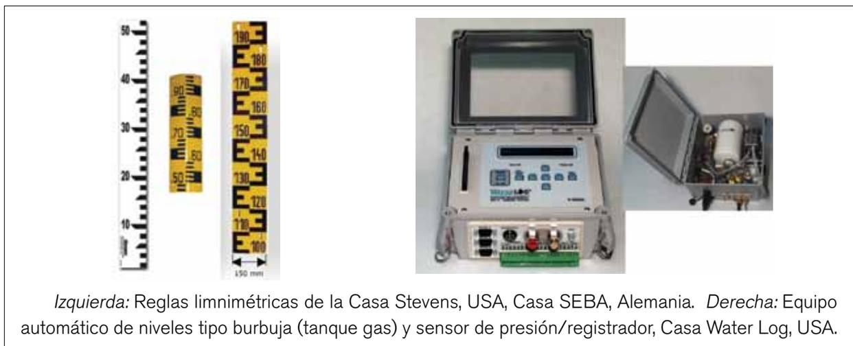
**FIGURA 8-6:** Ilustración de medidores de nivel de río
