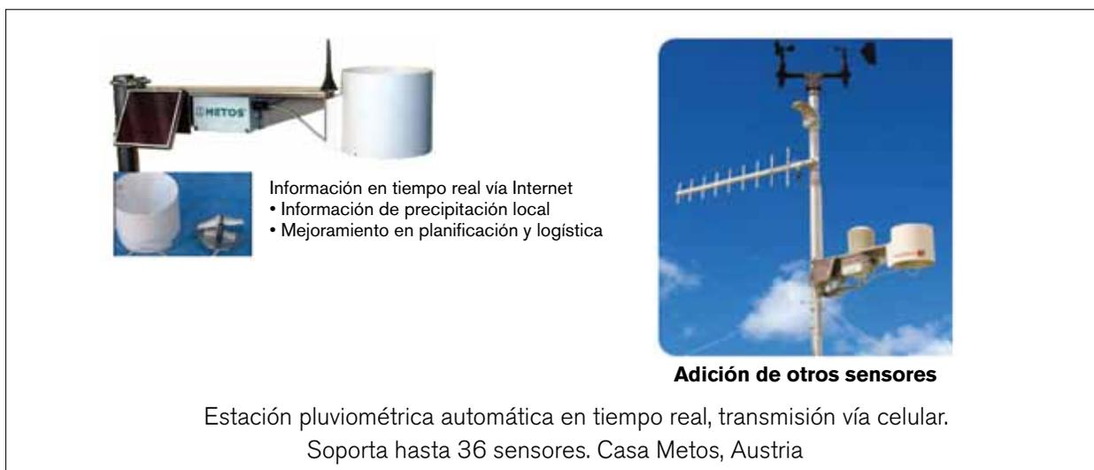
**FIGURA 8-5:** ilustración de estaciones pluviométricas automáticas
